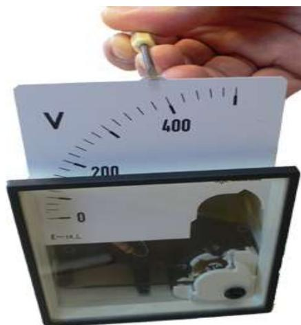
5. Introduzca la nueva escala con el mismo cuidado con el que ha quitado la anterior. La escala debe de ser introducida a través de las guías laterales interiores del instrumento.
