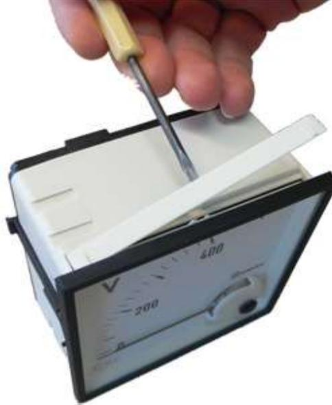
4. Introduzca la punta del destornillador en la ranura central de la escala y extráiga la misma lentamente. Tenga cuidado de no golpear la aguja del instrumento con la escala.
